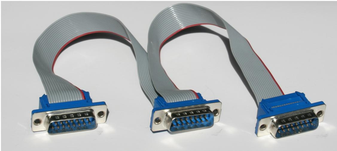
**Abbildung 3.59:** SXL II - I<sup>2</sup>C System-Bus Kabel
