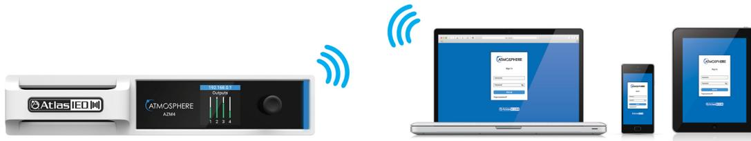
Abbildung 4.3: Verbindung per Access Point
